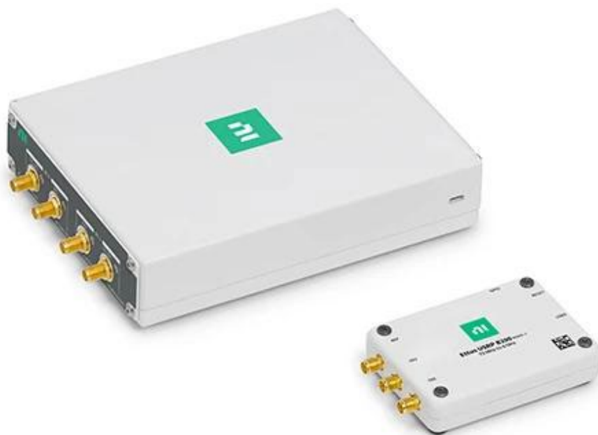
图 4. 低 SWaP-C 的 USRP 2901 和 USRP B200mini SDR
