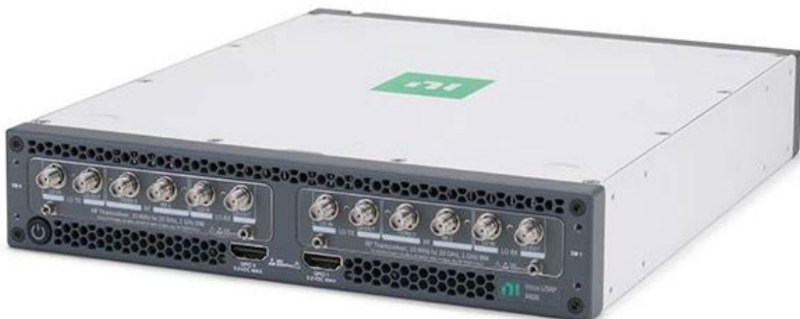
图 2. 基于 RFSoc 打造的 Ettus USRP X420 是一款高频率带宽 SDR，中心频率最高可达 20 GHz
